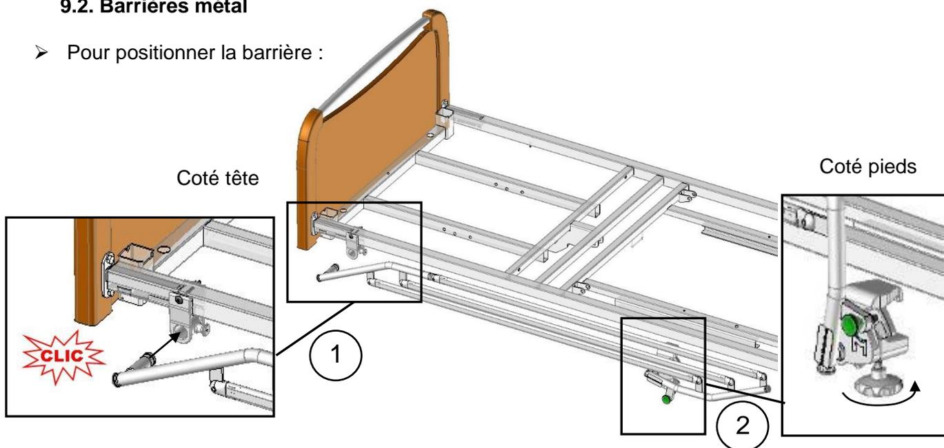
① Insérer le montant de la barrière pliée dans la mâchoire coté tête fixée sur le lit jusqu'à entendre le «CLIC»
