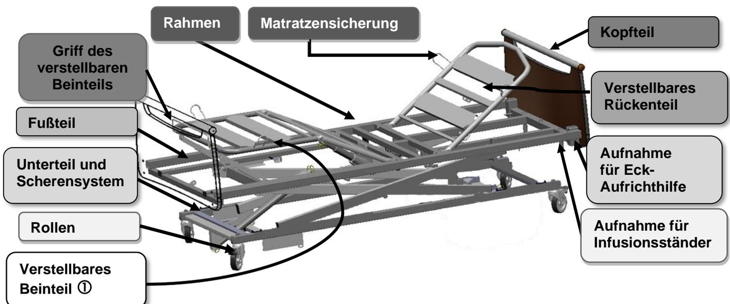
① Verstellbares Beinteil je nach Ausführung mit Zahnstangen oder mit elektrischer Knieknick-Verstellung
