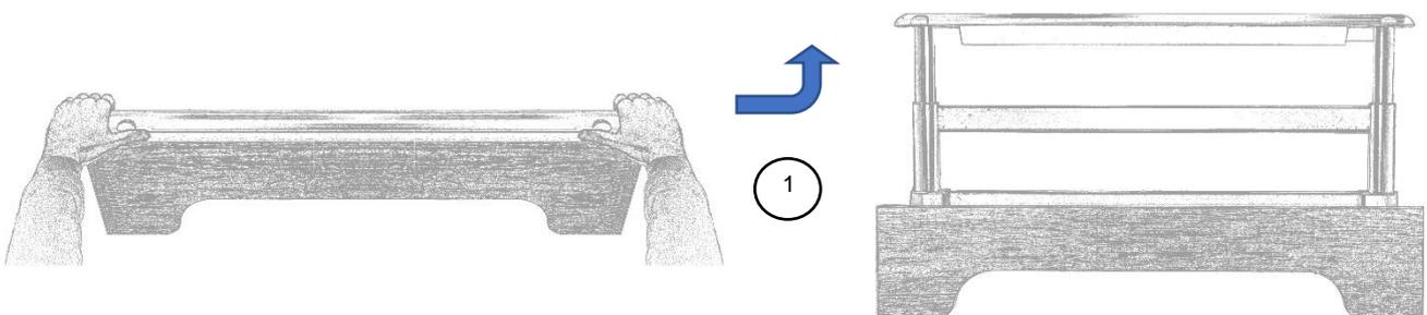
② Prüfen, dass die Seitensicherung sicher eingerastet ist, indem man versucht, sie zu klappen, ohne den Entriegelungszapfen zu betätigen.
