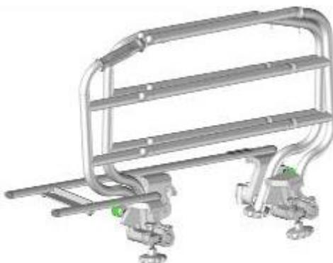
O sistema de apoio à mobilidade está previsto para ser utilizado em camas WINNCARE com comprimento de 2000 mm e com um estrutura realizada em tubo quadrado de, no máximo, 40 mm.
