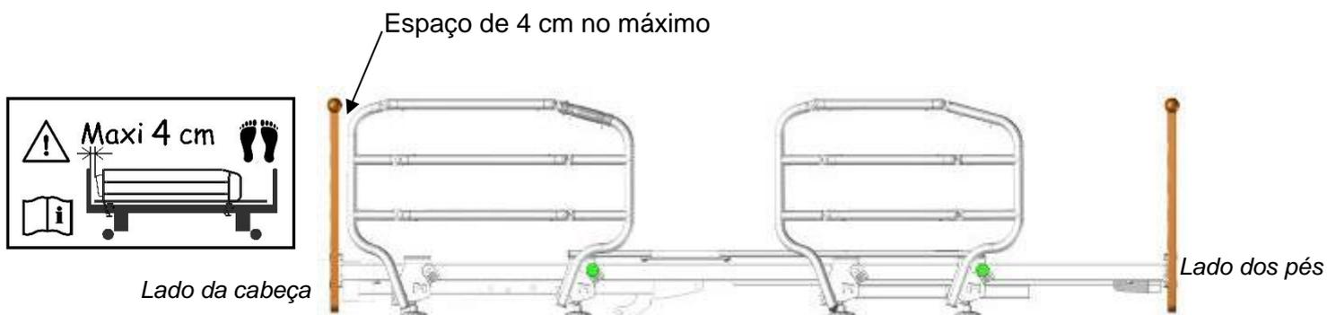
Para montá-los na cama, em primeiro lugar, posicione a parte mais comprida do lado da cabeça apertando as duas peças de aperto nas pinças. Depois, desdobre a última parte para o lado dos pés e, de seguida, aperte também as pinças e garanta o seu bloqueio.
