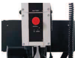
Skrzynka kontrolna Linak z odłączalnym akumulatorem. Mechaniczny wyłącznik awaryjny
